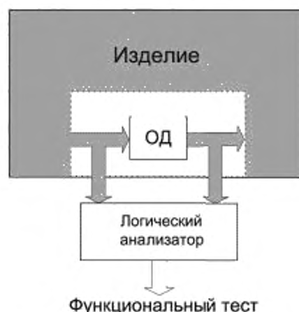
Рисунок 2 — Схема получения функционального теста с помощью логического анализатора
