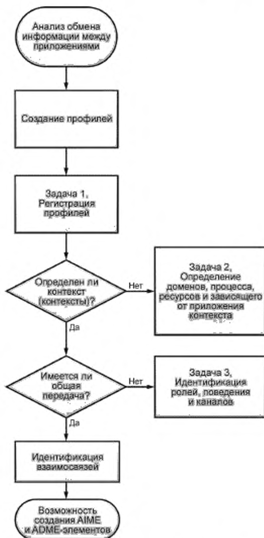
Рисунок 10 — Диаграмма, иллюстрирующая процедуру формирования AIME- и ADME-элементов
