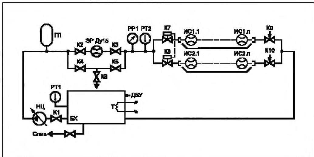
БХ — бак-хранилище; ГП — стабилизатор потока; К1...К10 — запорная и регулирующая арматура; НЦ — насос циркуляционный; ДВУ — датчик верхнего уровня; РТ — преобразователь температуры; РР — преобразователь давления; ЭР — расходомер; ИС — испытуемый счетчик; Т — нагревательный элемент (для ресурсных испытаний счетчиков горячей воды и универсальных счетчиков)
