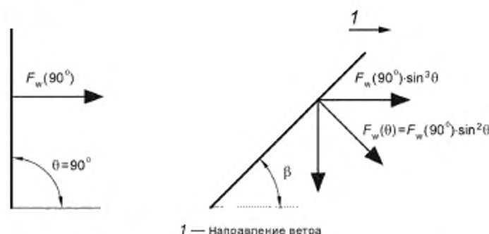
Рисунок 7 — Силы, действующие на наклонный элемент
