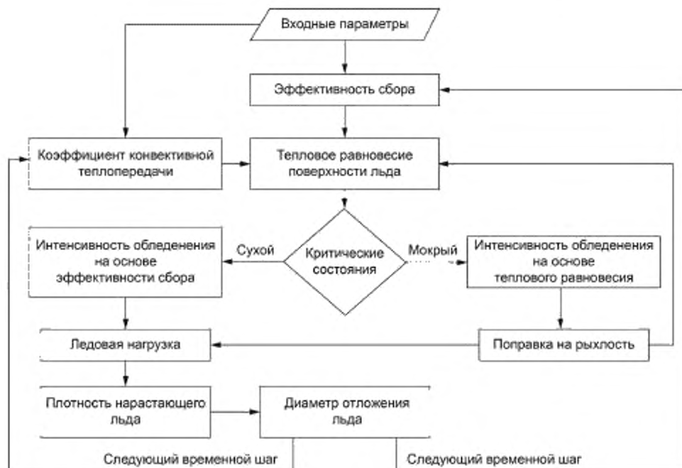
Рисунок С.5 — Упрощенная блок-схема численной модели обледенения
