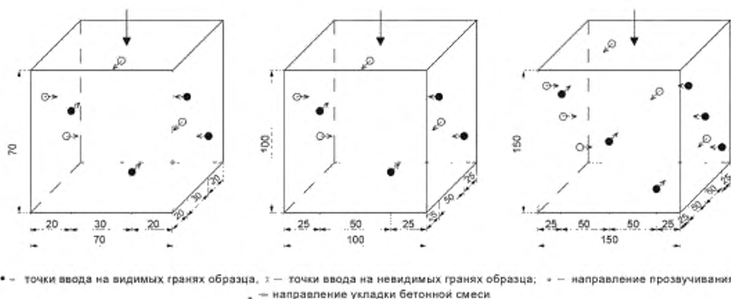
Рисунок 1 — Схема расположения точек ввода ультразвуковых колебаний
