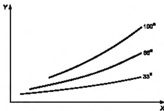
Обозначения.  $X$  — скорость в  $\text{мм}/\text{с}$ ;  $Y$  — время остановки в с.  $a$  — нагрузка в %
