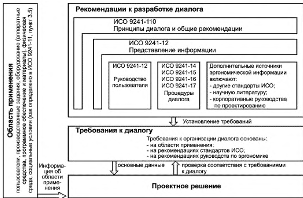
Рисунок 1 — Структурная схема применения настоящего стандарта
