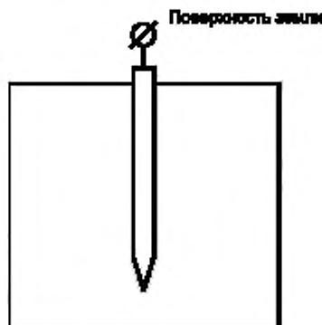
01-12-06 анодный заземлитель графито-пластовый: Заземлитель, выполненный из порошка — углеродита, скрепленного связующим материалом — термореактивной смолой.
