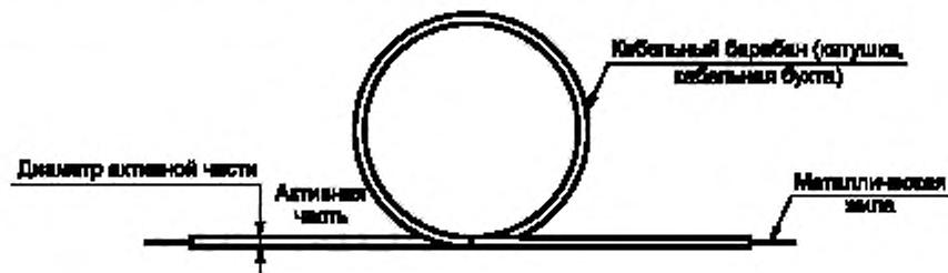
**01-12-10 анодный заземлитель протяженный гибкий:** Заземлитель, выполненный из электропроводного полимерного материала, отношение активной части к ее поперечному размеру превышает 10 000, а активная часть выдерживает знакопеременный изгиб в количестве не менее 20 циклов без изменения электрофизических свойств.
