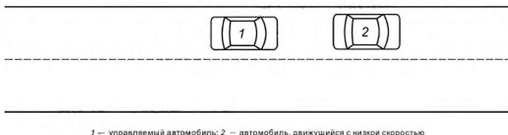
Рисунок 17 — Тестирование способности к автоматической смене траектории движения (конечные условия)
