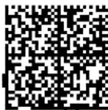
Рисунок A.3 — Тестовый символ для параметра «повреждение фиксированных шаблонов» (Fixed Pattern Damage) (символ Data Matrix)
