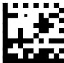
Рисунок А.1 — Пример тестового символа для параметра «модуляция» (Modulation)
