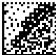
Рисунок А.2 — Тестовый символ для параметра «неиспользуемое исправление ошибок» (Unused Error Correction)
