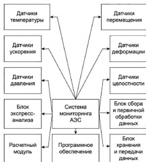
Рисунок 1 — Схема структурного состава СМНЭП
