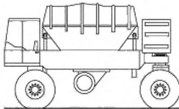
Рисунок 1 — Разбрасыватели для порошкообразных связующих
