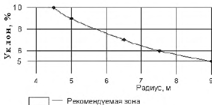
Рисунок А.2 — Взаимосвязь внутреннего радиуса винтового пандуса и величины его уклона
