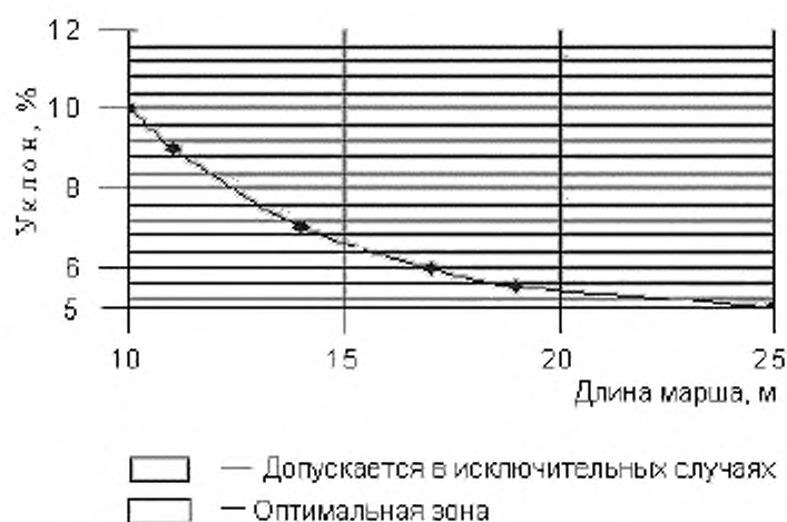
Рисунок А.1 — Взаимосвязь длины марша пандуса и величины его уклона
