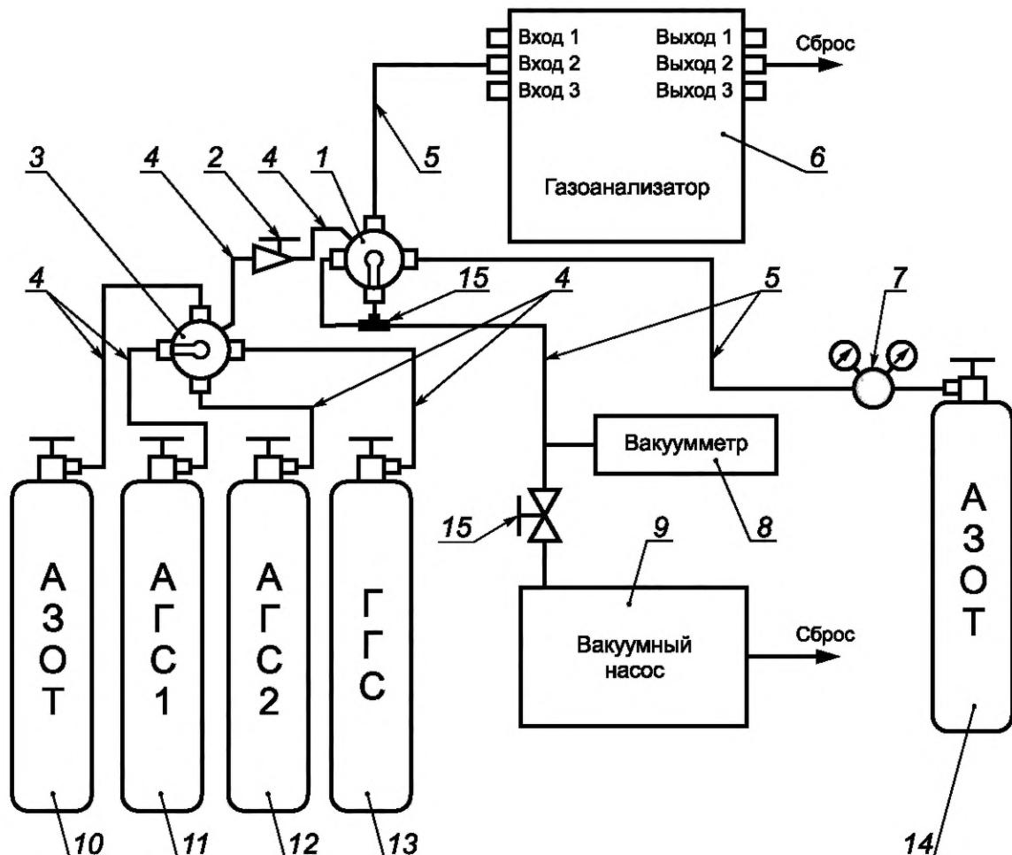
1, 3 — краник пятиходовый; 2 — вентиль тонкой регулировки; 4 — трубы из нержавеющей стали 6x3 мм; 5 — трубы фторопластовые 6x4 мм; 6 — газоанализатор (вид сверху); 7 — редуктор; 8 — вакуумметр; 9 — вакуумный насос; 10 — баллон с нулевым газом (азотом); 11 — баллон с анализируемой газовой смесью № 1; 12 — баллон с анализируемой газовой смесью № 2; 13 — баллон с градуировочной газовой смесью; 14 — баллон со вспомогательным (продувочным) азотом
