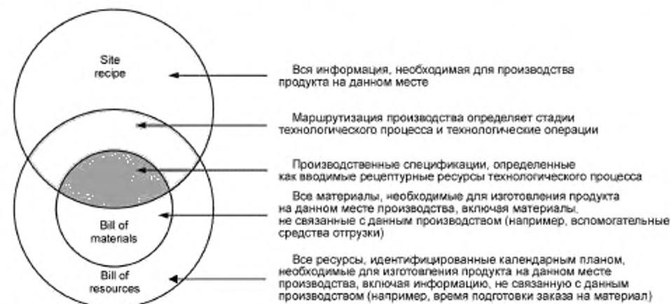
Рисунок С.1 — Типовое наложение информации рецептуры, связанной с местом производства, спецификации материалов и спецификации ресурсов
