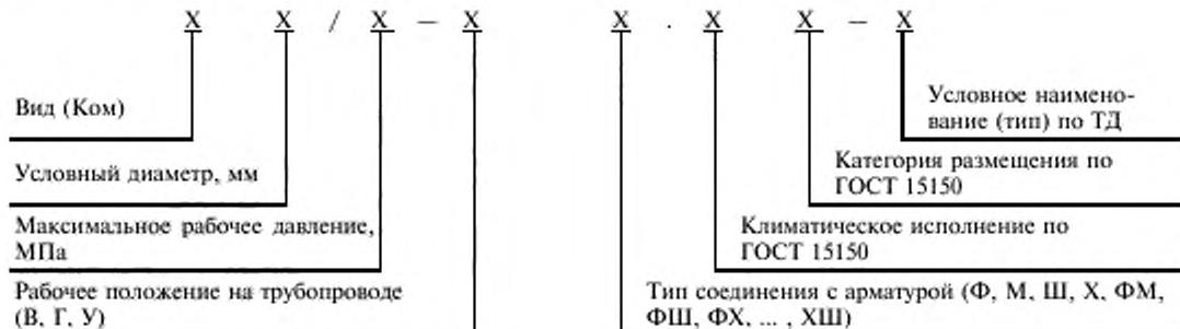
5.11.2 Пример условного обозначения компенсатора с проходом условным диаметром 10 мм, максимальным рабочим давлением 1,2 МПа, вертикальным рабочим положением на трубопроводе, муфтовым типом соединения с арматурой, климатическим исполнением У, категорией размещения 4, условным наименованием «Патрон»:
