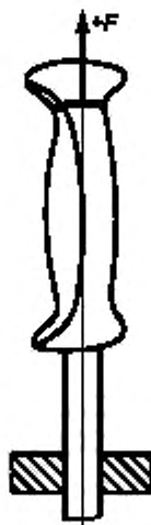
Рисунок 6 — Схема испытания на надежность соединения ручки со стержнем
