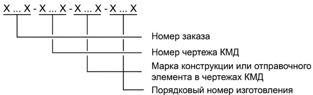
Рисунок 4 — Структура марки готовых конструкций, изделий или отправочных элементов
