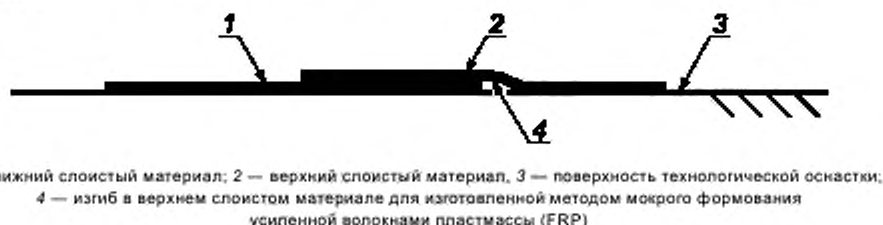
Рисунок 1 — Взаимовлияние в полученном способом мокрого формования образце FRP из-за изгиба в верхнем слоистом материале
