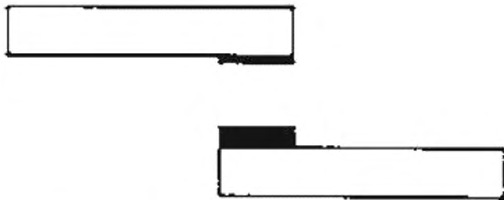
Рисунок А.3 — Схематическое изображение тонкослойного когезионного разрушения
