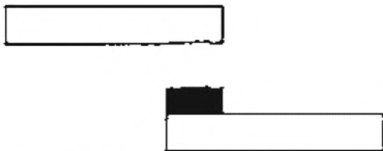
Рисунок А.5 — Схематическое изображение разрушения из-за слабого разрыва волокон
