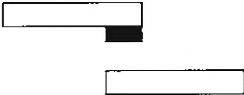
Рисунок А.1 — Схематическое изображение адгезионного разрушения
