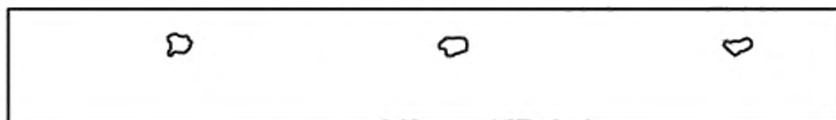
c — пример 3: три дефекта размером 4,0 мм
