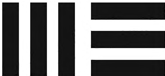
Рисунок 2 — Тест-объект для проверки разрешающей способности
