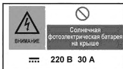
Рисунок F.6 — Пример знака, информирующего об опасности возникновения пожара на главном распределительном щите здания, и идентичный знак МЭК
