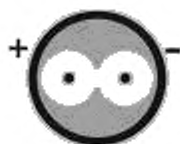
Рисунок 12с — Кабель в стальной оплетке (обычно применяемый только для выходного кабеля ФБ или кабелей фотоэлектрических групп в больших ФБ)
