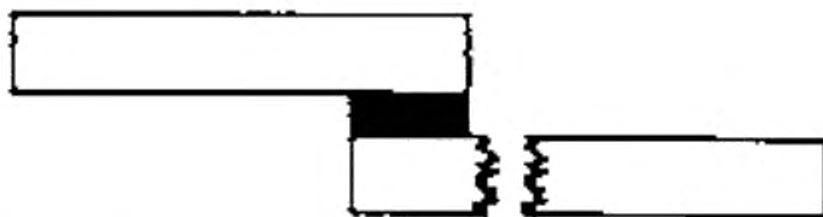
Рисунок А.6 – Схематическое изображение разрушения из-за разрыва материала
