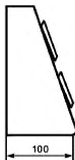
Рисунок F.1 — Пример управления XL устройства в кабине лифта (вид сбоку)
