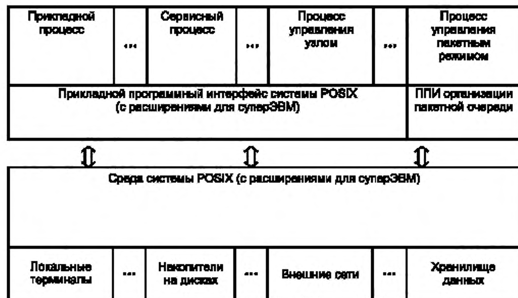
Рисунок 1 — Модель среды суперЭВМ на основе POSIX
