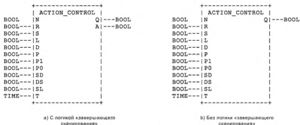
Рисунок 22 — Функциональный блок ACTION\_CONTROL — Внешний интерфейс (сводка)
