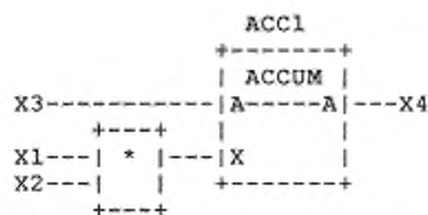
д) Допустимое использование экземпляра функционального блока
