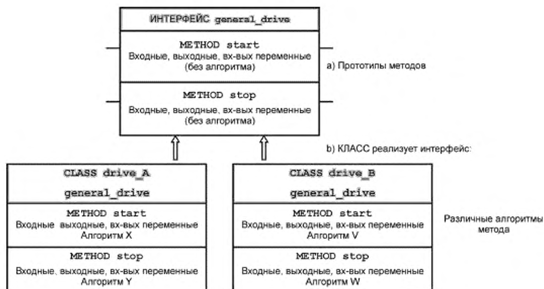
Рисунок 18 — Интерфейс с порожденными классами (иллюстрация)
