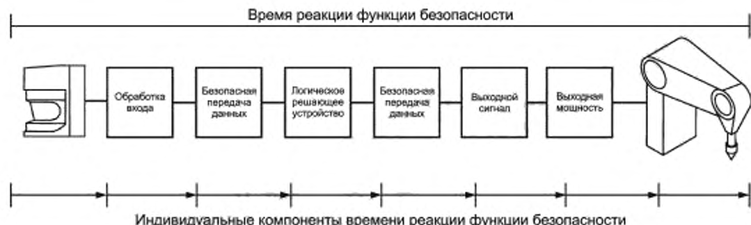
Рисунок 5 — Пример компонентов, составляющих время реакции функции безопасности
