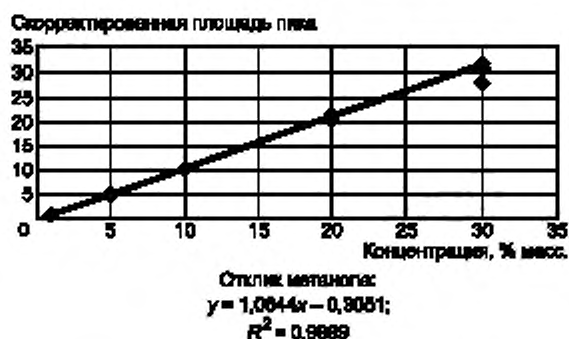
Рисунок А2.1 — Определение расчетного отклика при анализе метанола методом ИА
