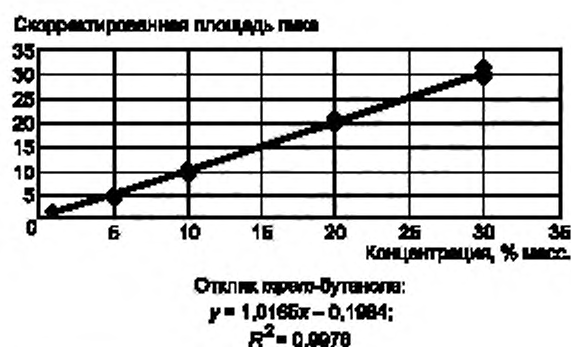
Рисунок А2.3 — Определение расчетного отклика при анализе трет-бутанола методом ИНА
