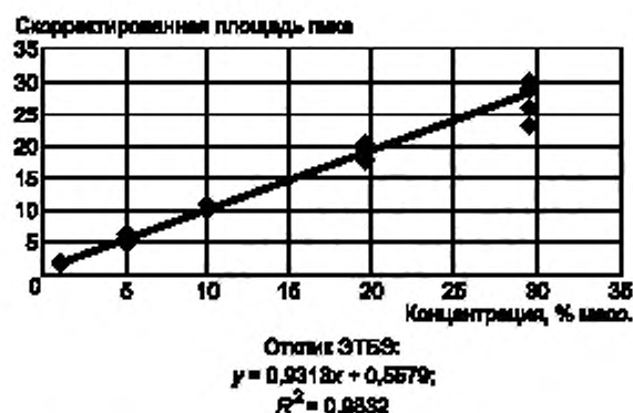
Рисунок А2.5 — Определение расчетного отклика при анализе ЭТБЭ методом ИНА
