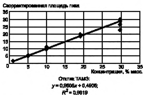
Рисунок А2.6 — Определение расчетного отклика при анализе ТАМЭ методом ИНА
