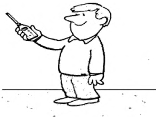
Рисунок 2 — Пример перемещения шумомера во время измерений
