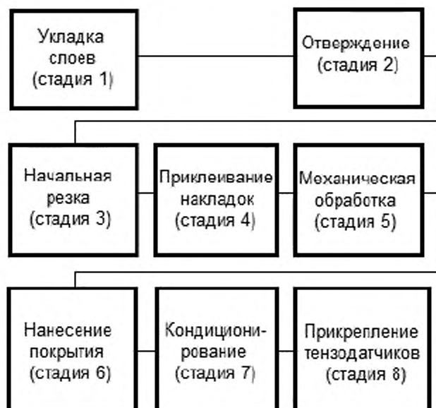
Рисунок 1 — Процесс изготовления образцов для испытания
