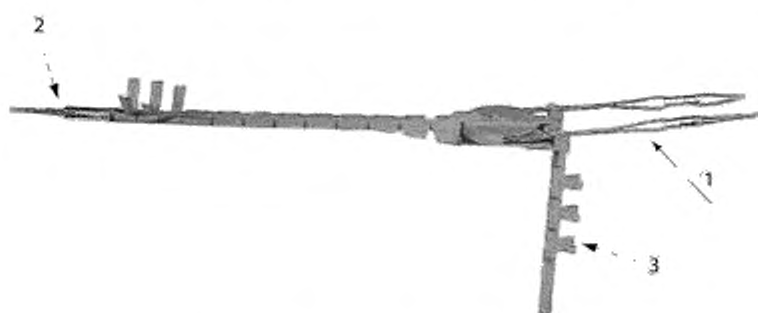
1 — провод, 2 — протягиваемый трос, 3 — хвостовик
