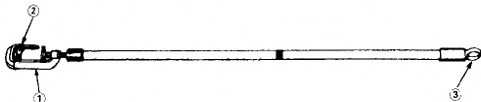
1 — головка; 2 — ролик; 3 — поворотное кольцо
