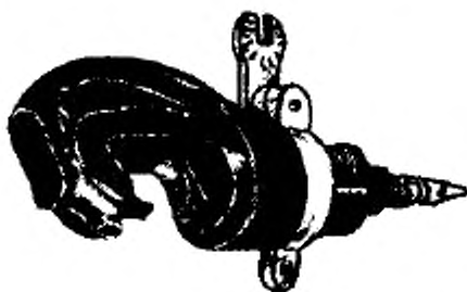
Гидравлический пресс для использования с изолирующей штангой
