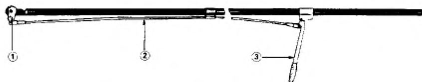
1 — режущая головка; 2 — тяга; 3 — рычаг управления Рычажный тип (облегченный режим работы)
