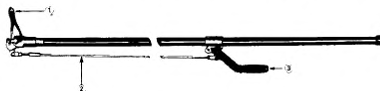
1 — кусачки; 2 — тяга, 3 — рычаг управления
