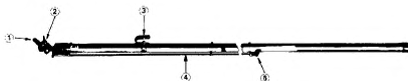
1 — головка, 2 — привод, 3 — крючок вешалки; 4 — тяга; 5 — рычаг управления
