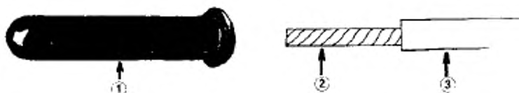
1 — колпачок; 2 — оголенный провод; 3 — изоляции
