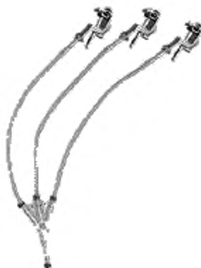
Короткозамыкающие кабели, соединяющие зажимы с клеммной колодкой
