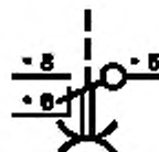
Переключающий контакт с замедлением в обоих направлениях
