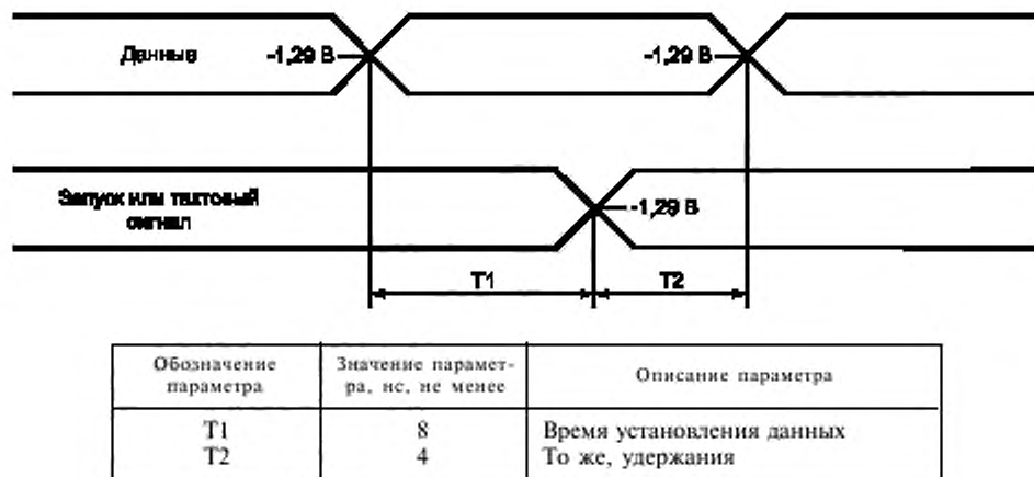
Рисунок В.12 — Передача данных по линиям ECLTRG
