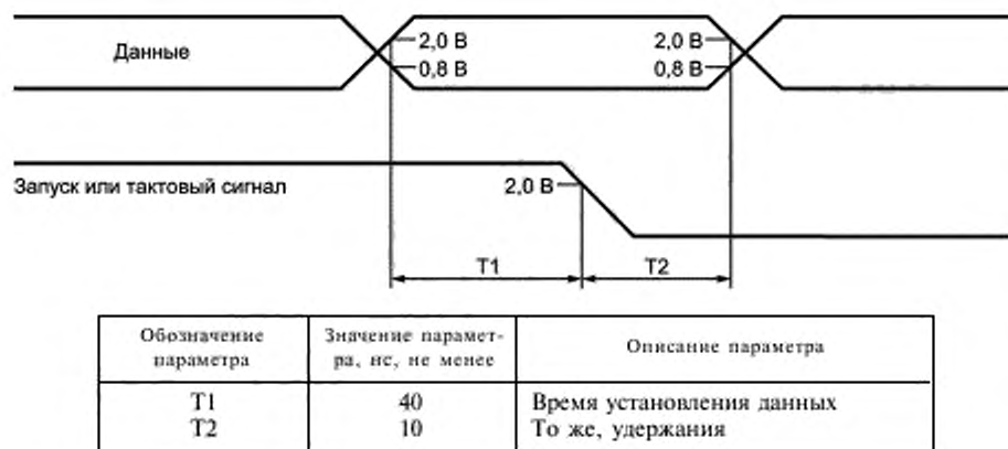
Рисунок В.5 — Передача данных по линиям TTLTRG* с синхронизацией по отрицательному перепаду тактового сигнала
