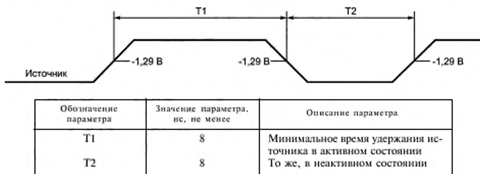
Рисунок В.10 — Синхронный (SYNC) протокол запуска для линий ECLTRG
