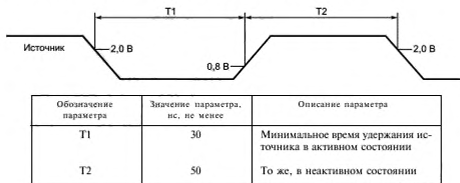
Рисунок В.3 — Синхронный (SYNC) протокол запуска для линий TTLTRG*
