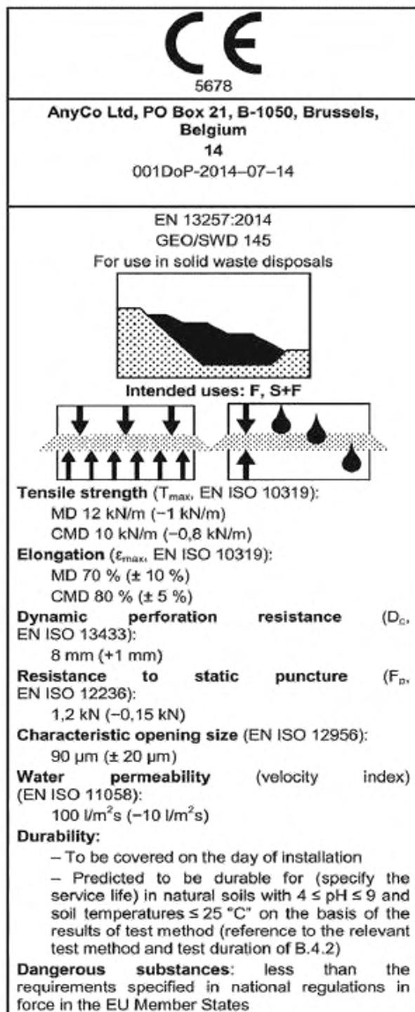
Рисунок Г.1 — Пример размещенной на продукции, этикетке, упаковке или в сопроводительных документах CE-информации для продукции, сертифицированной по системе AVCP 2+
