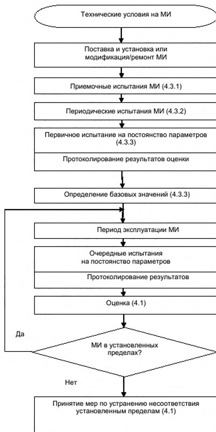
Рисунок 1 – Общая схема проведения контроля
