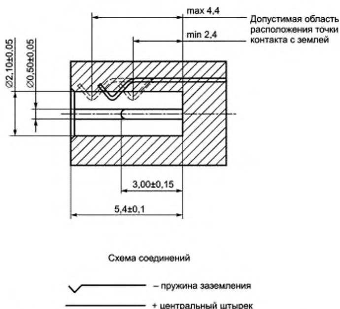
Рисунок С.2 — Зарядная розетка двухмиллиметрового цилиндрического интерфейса. Подробная информация
