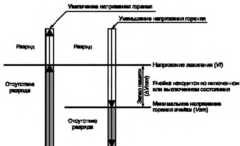
Рисунок А.2 — Разрядные характеристики ячейки (статистические характеристики единичной ячейки)
