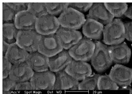
Рисунок С.42 — РЭМ: поперечное сечение бикомпонентного ПЭ/ПП волокна
