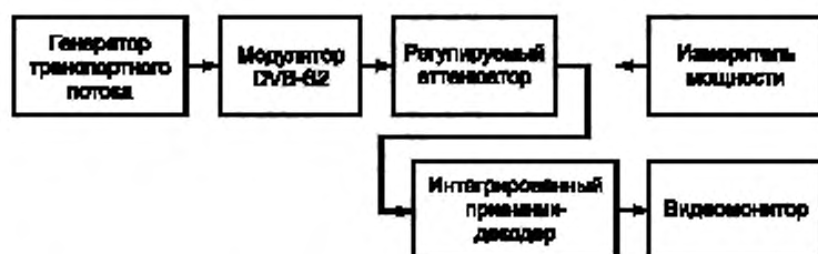
Рисунок 2 — Схема измерения чувствительности и максимального уровня принимаемого сигнала
