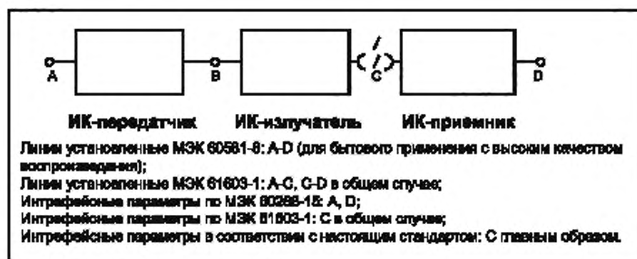
Рисунок 1 — Цель передачи сигнала и соответствующие стандарты МЭК
