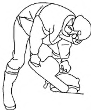
Рисунок 3 — Пример удерживания отрезного станка в стандартной позиции резания
