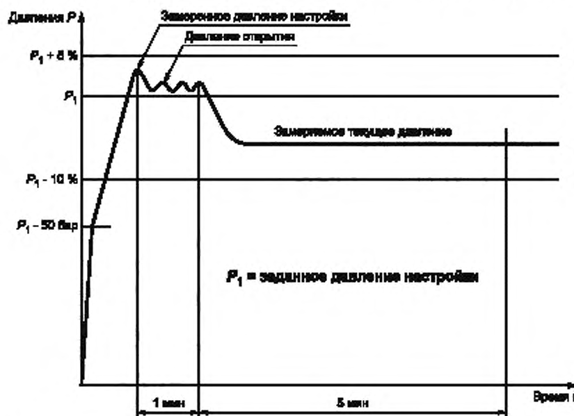
Рисунок А.2 — Пример характерного протекания процесса «давление/время» для предохранительного клапана
