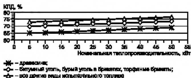
Рисунок 1 — КПД при номинальной теплопроизводительности
