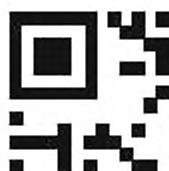
Рисунок 1.3 — Размещение модулей данных в символе до маскирования данных
