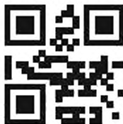
Рисунок 1.1 — Размещение модулей данных в символе до маскирования данных
