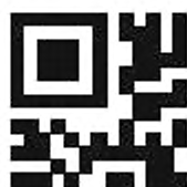
Рисунок 1.4 — Окончательный вид символа версии M2-L, кодирующего 01234567
