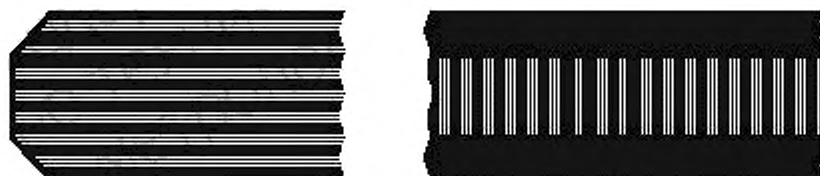
Рисунок А.3 — Гладкошлифованная кромка
