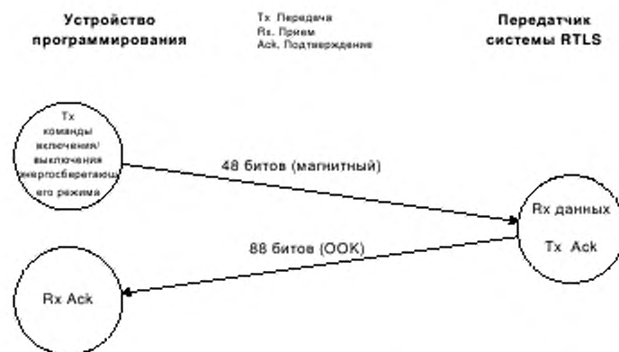
Рисунок 12 — Обмен сообщениями между устройством программирования и передатчиком системы RTLS для передачи команды включения/выключения энергосберегающего режима
