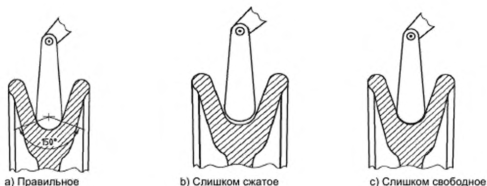
Рисунок С.4 – Проверка шкивов
