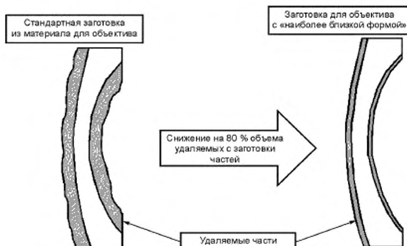
Рисунок С.3 — Заготовка для объектива с «наиболее близкой формой»
