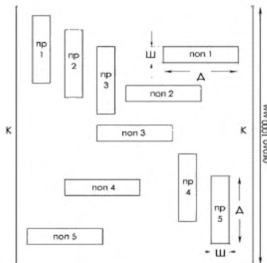
Условные обозначения: пр — пробы, вырезанные в продольном направлении; поп — пробы, вырезанные в поперечном направлении; К — кромка; Δ — длина пробы; Ш — ширина пробы;
